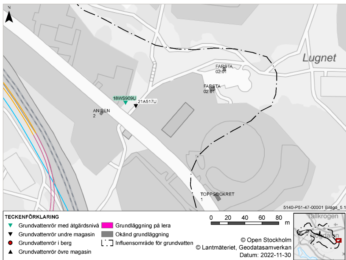
Figur 1: Grundvattenrör 18WS909U med åtgärdsnivåer för fastigheten Anisen 2
