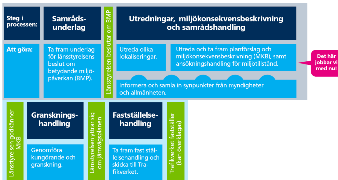
Figur 3. Planläggningsprocessen för en järnvägsplan som kan antas medföra betydande miljöpåverkan. Tunnelbanan till Älvsjö befinner sig i samrådsskedet. Figuren visar även sambandet med miljöprövningen.
