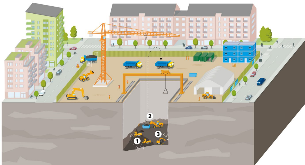
Figur 11. Illustration av ett sänkschakt med traverskran. 1) borra-spräng, 2) bergmassor lyfts upp till en lastbil, 3) bergväggarna förstärks med bultar och betong.
