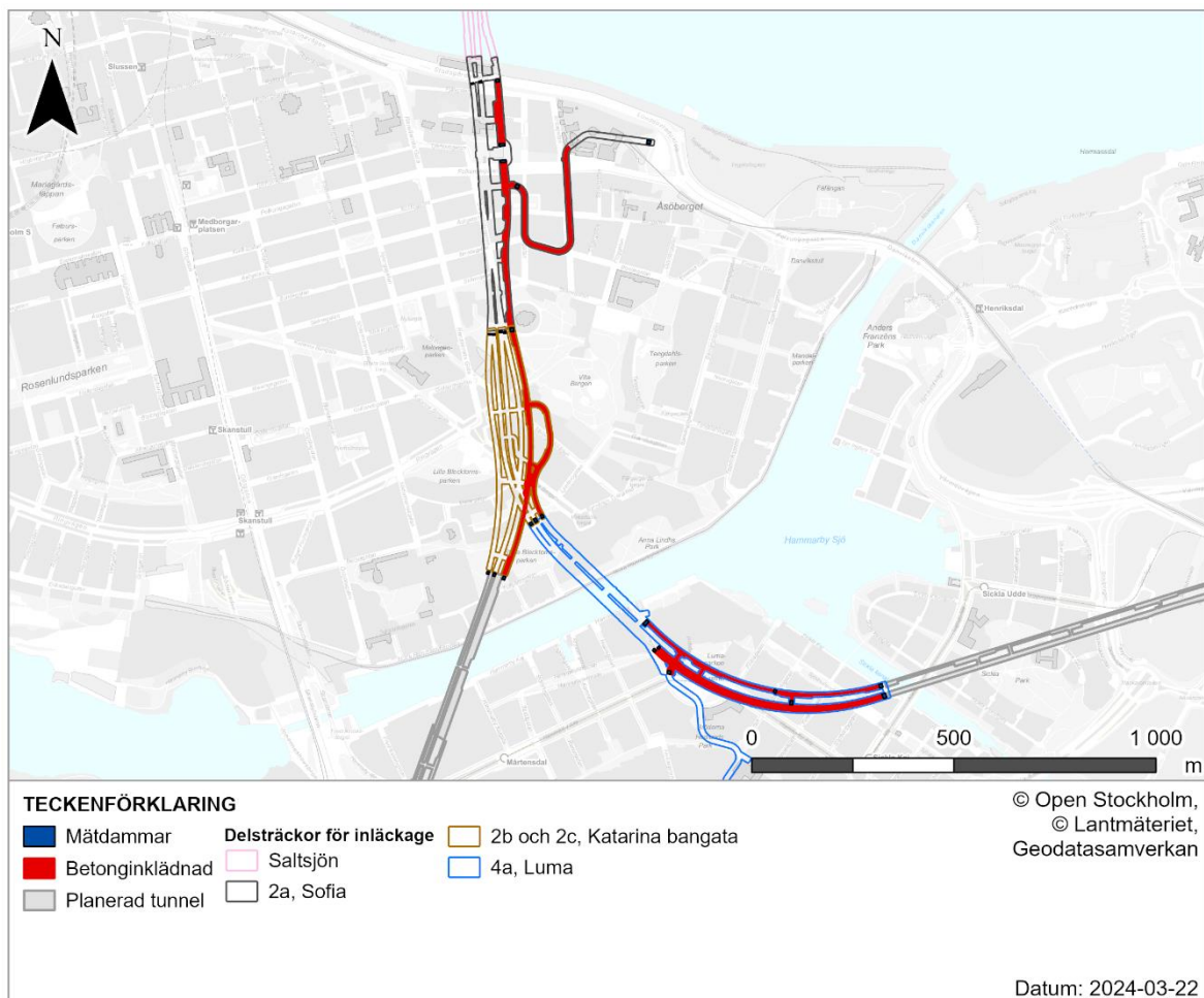
Figur 59. Delar av delsträckorna 2a Sofia, 2b och 2c Katarina Bangata och 4a Luma som skulle behöva kläs in med en betonginklädnad för att teoretiskt innehålla inläckagevillkoret för drifttiden för respektive delsträcka. Rödmarkerat i kartan illustrerar de tunneldelar där betonginklädnad skulle behöva utföras.
