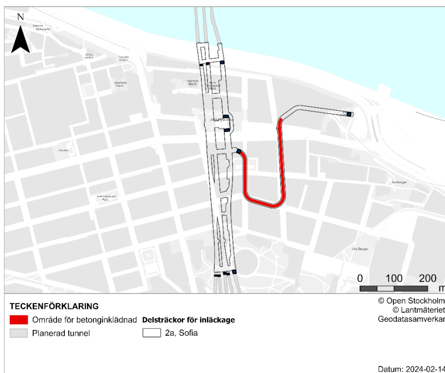
Figur 1. Omfattningen av betonginklädnaden inom delsträckorna 2a Sofia. Betonginklädnaden för detta steg omfattar arbetstunneln.
