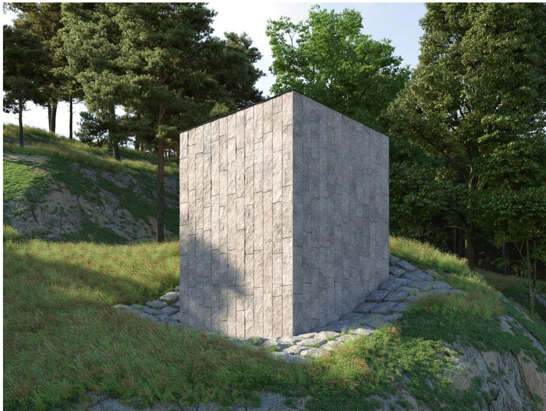
Figur 24. Exempel på principiell utformning av luftutbytestorn som överbyggnad till luftutbytesschakt ovan mark. Ej skalenlig.
