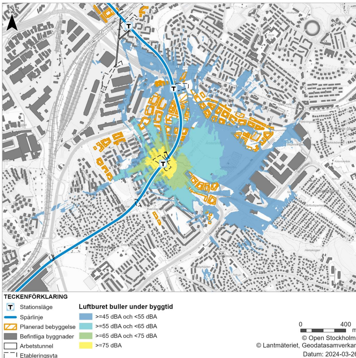
Figur 43. Ljudutbredning från spontning vid etableringsyta station Östbergahöjden. Redovisar ekvivalent ljudnivå 2 meter över mark.
