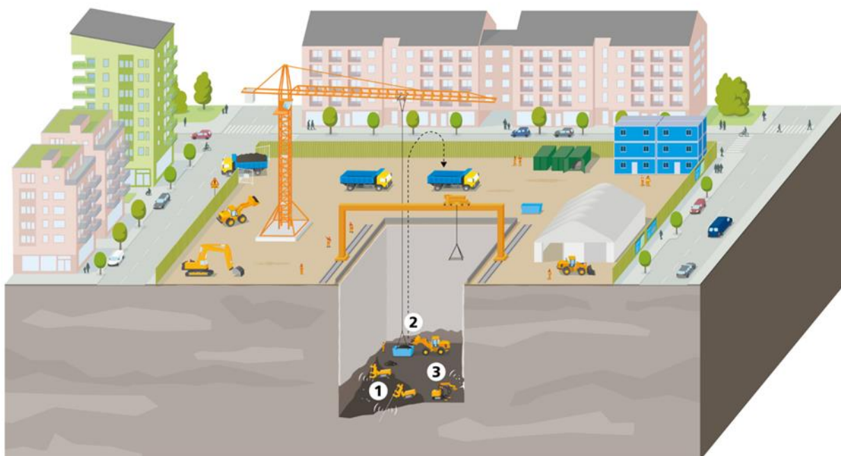
Figur 28. Illustration av ett sänkschakt med traverskran. 1) borra-spräng, 2) bergmassor lyfts upp till en lastbil, 3) bergväggarna förstärks med bultar och betong.
