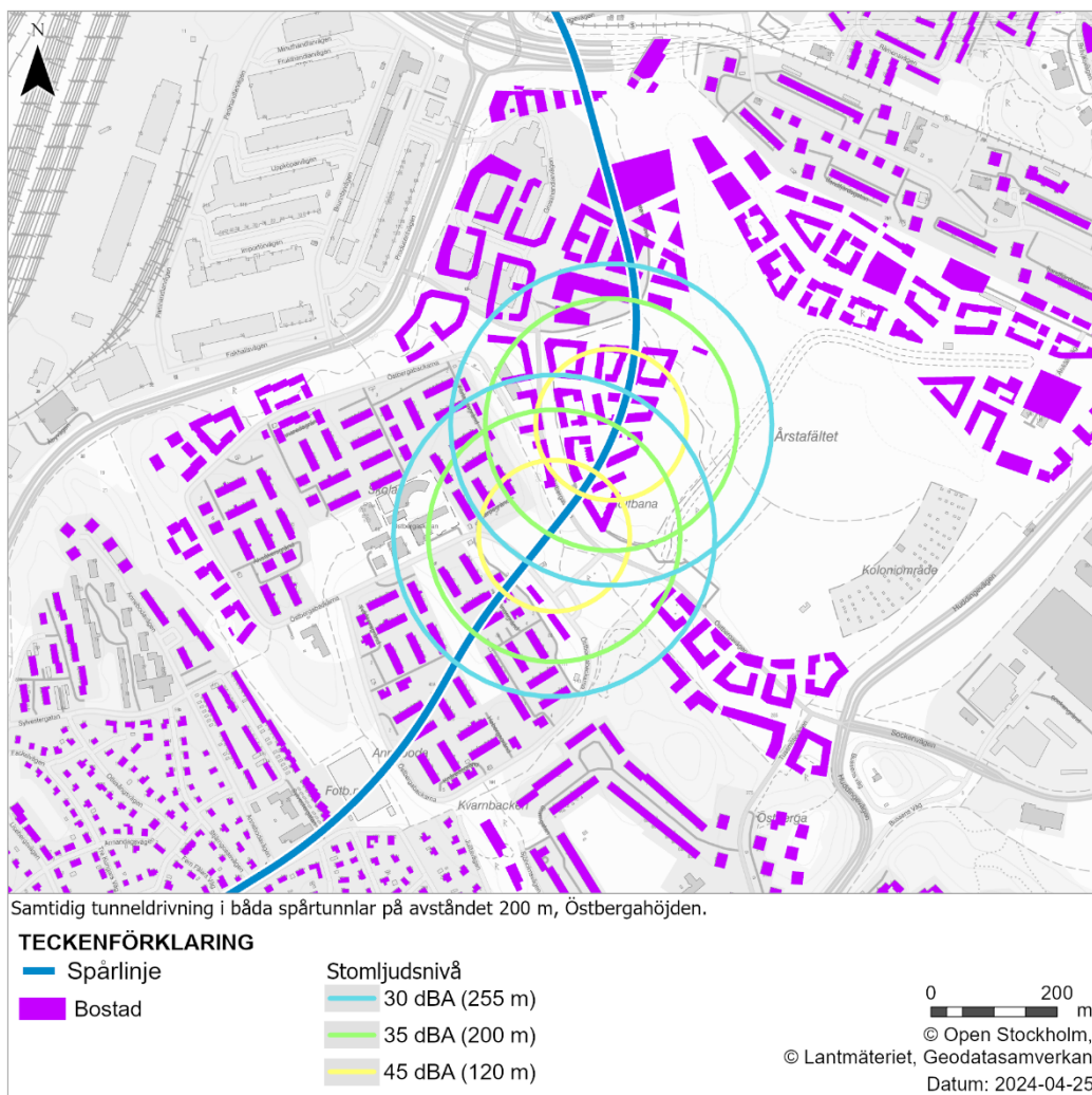
Figur 56. Spridning av stömljud vid passage av två tunnelbormaskiner på 200 meters avstånd från varandra. I exemplet är TBM placerade i mitten av respektive ring och i höjd med Östberga.
