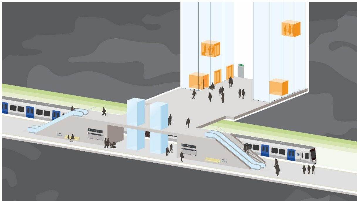
Figur 4-9. Illustration där förhållandet mellan plattform, vertikaltransport, mellanplan med hisshall och högkapacitetshissar visas.
