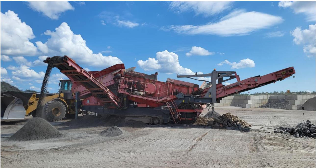
FIGUR 4. KROSSNING OCH PROVTAGNING AV BERGMATERIAL SOM REPRESENTERAR BATCH F.
