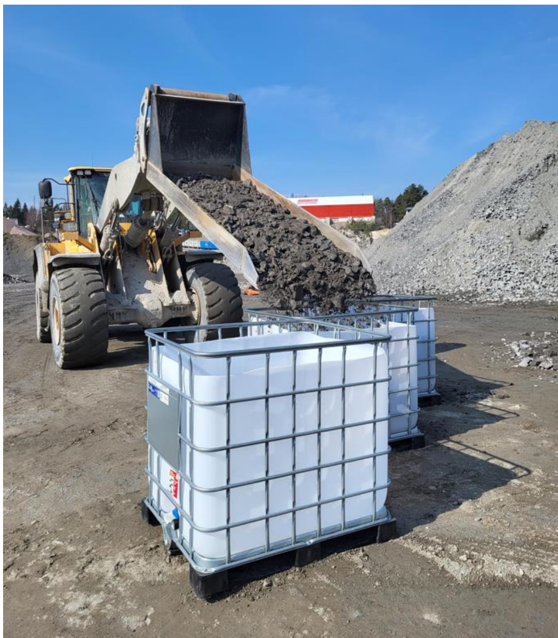
FIGUR 7. INLASTNING AV HOMOGENISERAT MATERIAL (CA 1 000 KG) I TRE IBC-TUNNOR (LAKTEST 1, 2 OCH 3) FÖR BATCH C.
