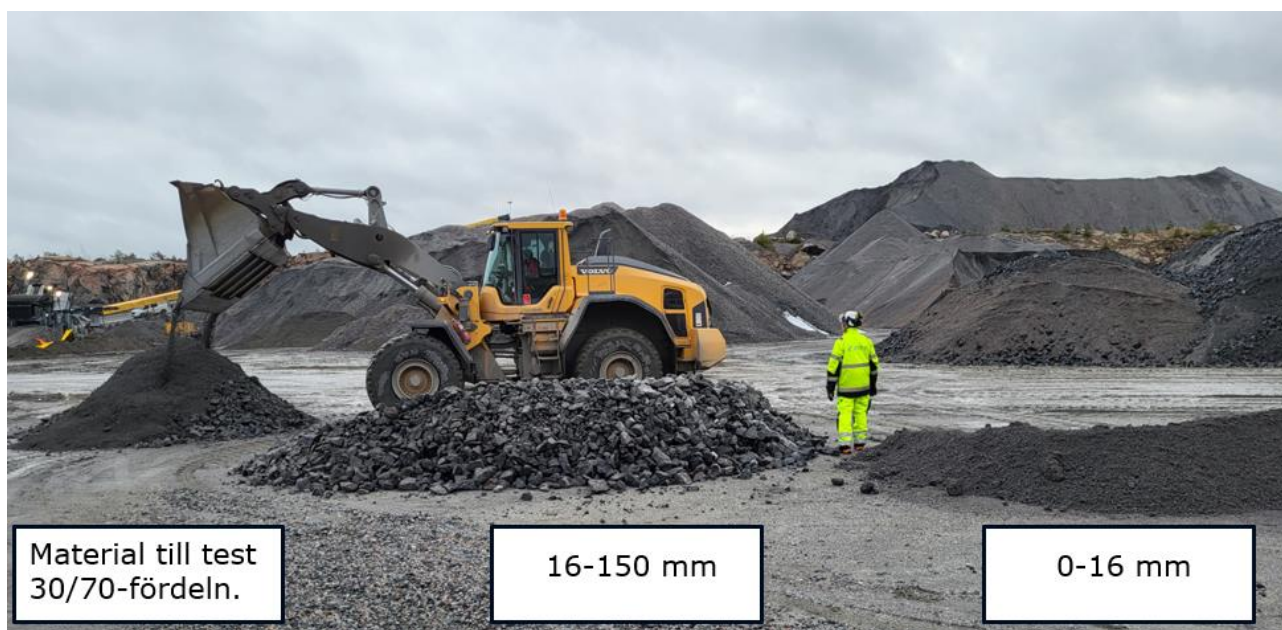
FIGUR 6. MATERIALFÖRDELNING INFÖR UPPSTART AV BATCH B.
