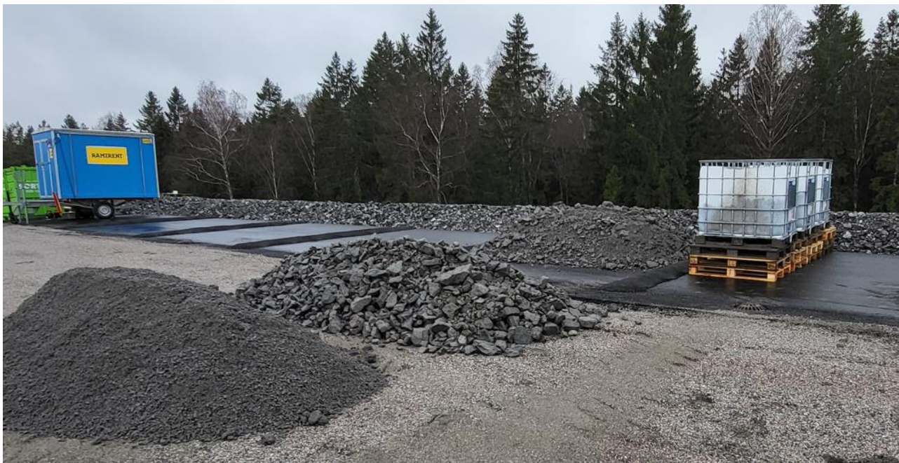
FIGUR 8. UPPSTART AV BATCH B. IBC-TUNNOR MED INTILLIGGANDE BERGHÖG UPPLAGDA PÅ DEN ASFALTERADE TESTYTAN. ÖVERBLIVET RESTMATERIAL FRÅN KROSSNINGEN (0–16 MM OCH 16–150 MM) UPPLAGT PÅ GRUSAD YTA.
