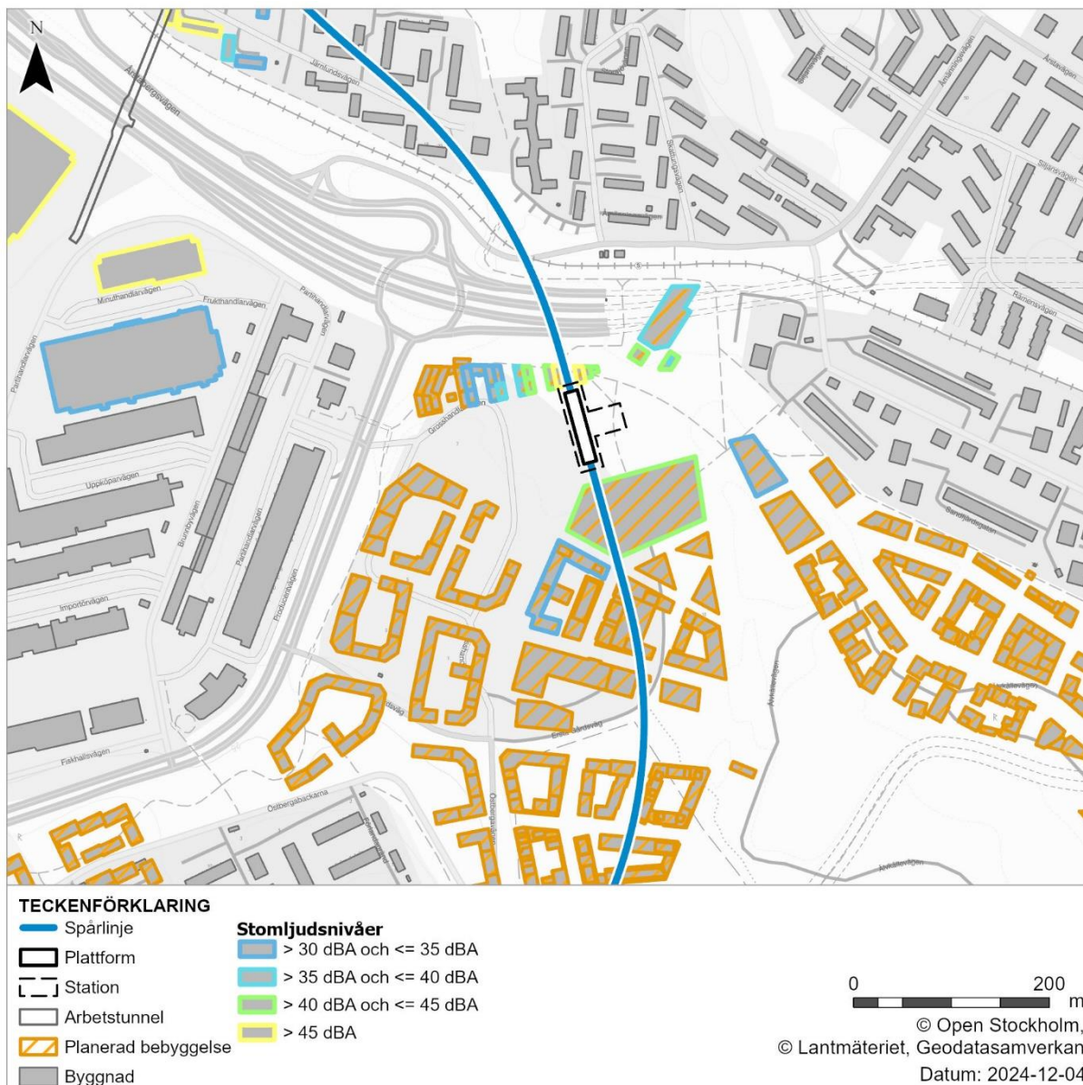
Figur 86. Ekvivalenta stomljuds nivåer inomhus från byggande av vertikalt schakt och stationsutrymmen vid Årstafältet. Även stomljuds nivåer från Årstabergets arbetstunnel redovisas i övre vänstra hörnet i figuren. Borrning och sprängning för sänkschakt och stationsutrymme pågår periodvis under cirka ett år och nio månader.
