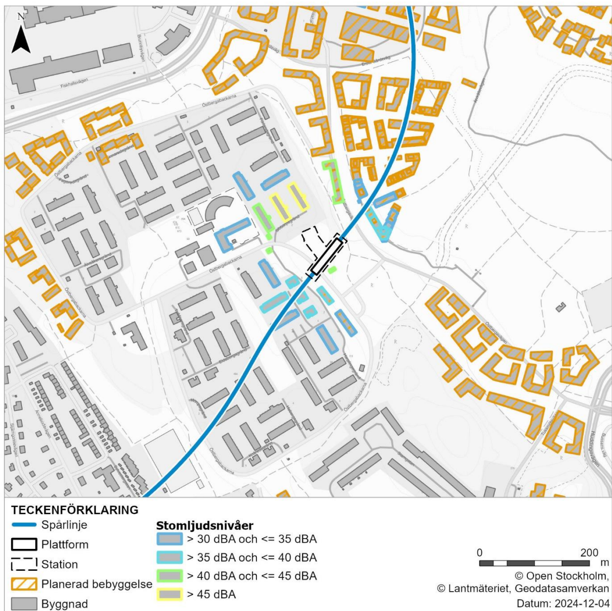
Figur 87. Ekvivalenta stomljudsnivåer inomhus från byggande av vertikalt schakt och stationsutrymmen för Östbergahöjden. Borrning och sprängning för sänkschakt och stationsutrymme pågår periodvis under kortare än tre år.
