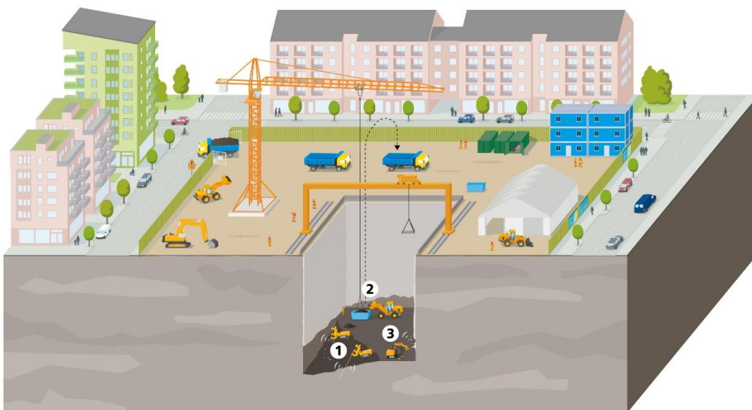
Figur 43. Principskiss för arbetsmetoden sänkschakt med kranar. 1) Borra-spräng, 2) Bergmassor lyfts upp till en lastbil, 3) Bergväggarna förstärks med bultar och betong. (OBS dessa aktiviteter sker inte samtidigt).
