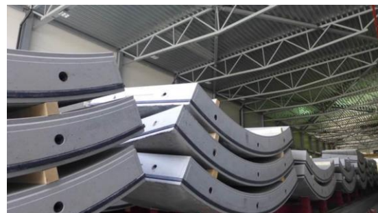
Figur 35. Betongsegment utgör del av tunnelns betonginklädnad. Vid det som blir segmentens fogar finns en gummilist.
