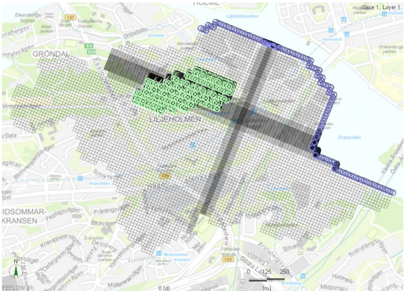
Figur 6. Plan vy av Liljeholmsmodellen. Fluid-transfer Boundary Condition (gröna ringar) representerar Trekanten, Hydraulic-Head Boundary Condition (lila ringar) sattes vid Årsta- och Liljeholmsviken. Stationen ligger i området för finat beräkningsnät.
