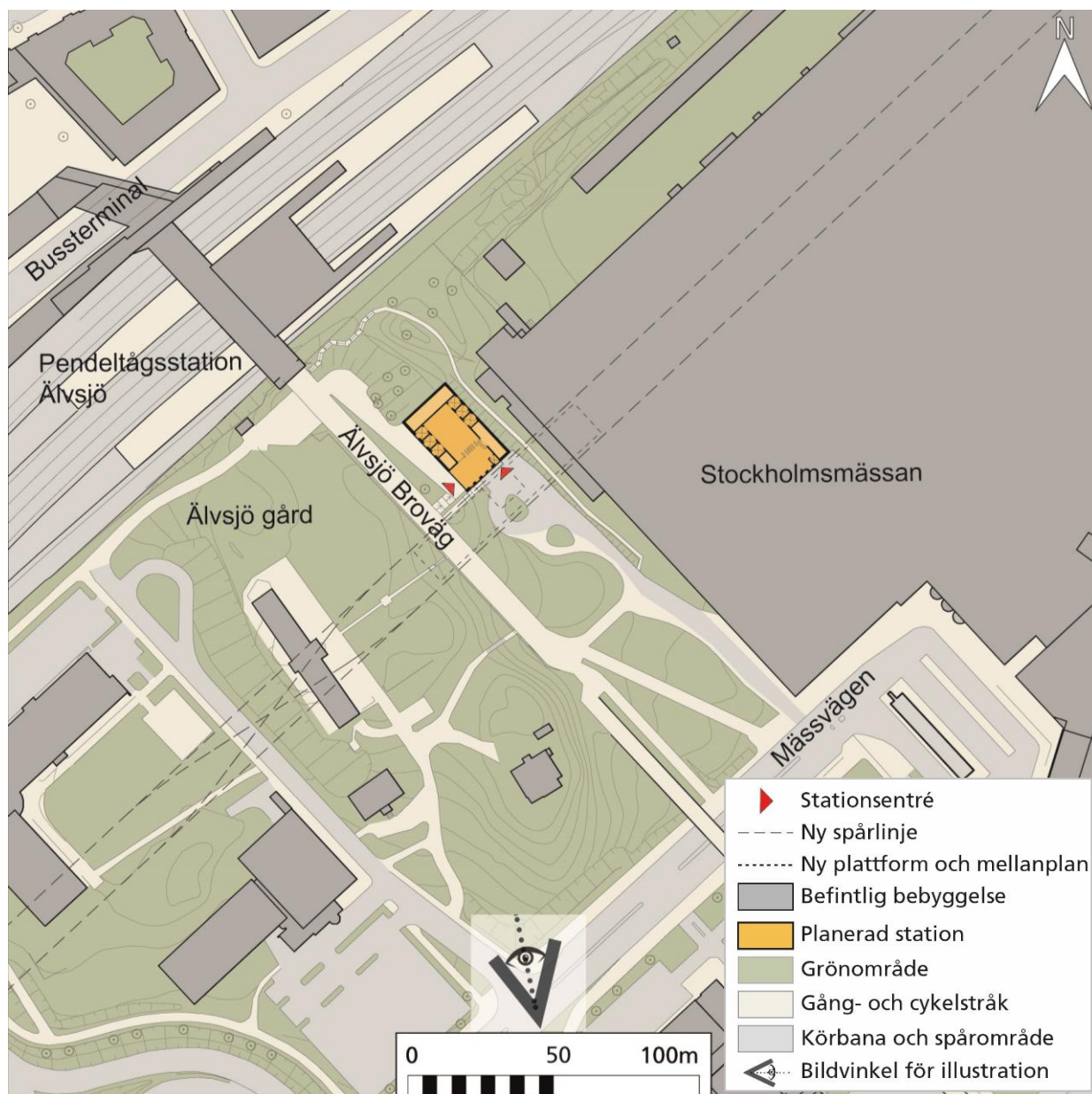
Figur 4-34. Station Älvsjö. Den planerade stationsbyggnaden är fristående med stationsentré mot Älvsjö Broväg.
