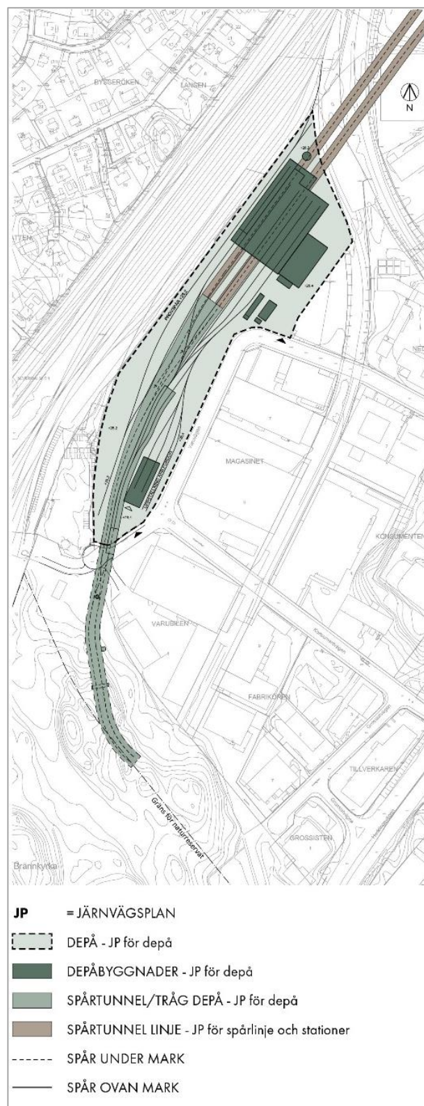
Figur 9-2. Situationsplanen illustrerar gränsen mellan järnvägsplanen för spårlinje (brun yta) och järnvägsplan för depå (gröna ytor).
