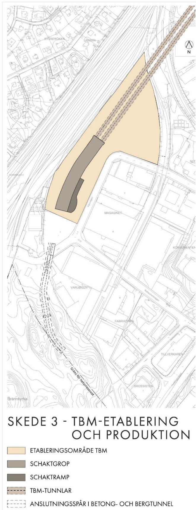
Figur 36. Arbeten med tunnelbormaskinen (TBM) som sker på inom depån i skede 3.
