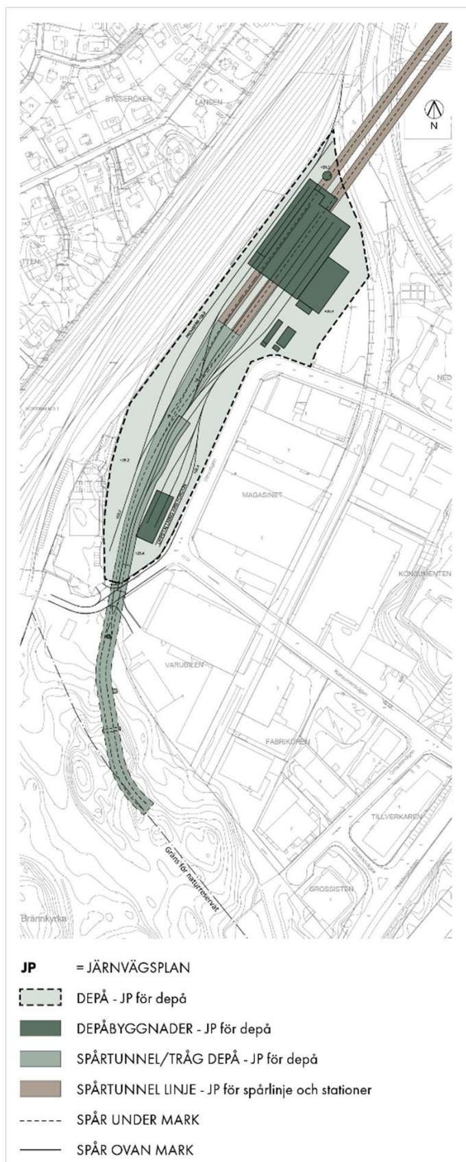
Figur 25. Depån med byggnader för uppställning, verkstad och hall för arbetsfordon i mörkgrönt.
