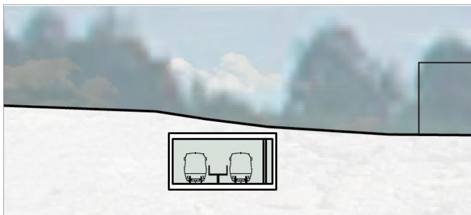
Figur 28. Principskiss för spårtunnel i betong.
