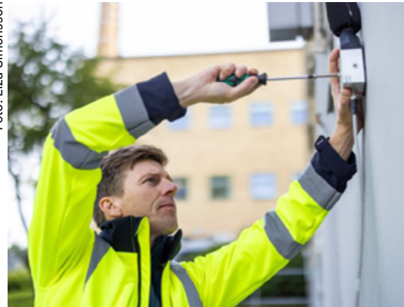
Många mätningar håller koll på hur bygget påverkar omgivningen. På bilden monteras en decibelmätare på fasaden av ett hus.
