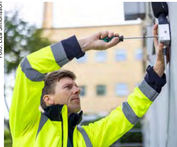
Många mätningar håller koll på hur bygget påverkar omgivningen. På bilden monteras en decibelmätare på fasaden av ett hus.
