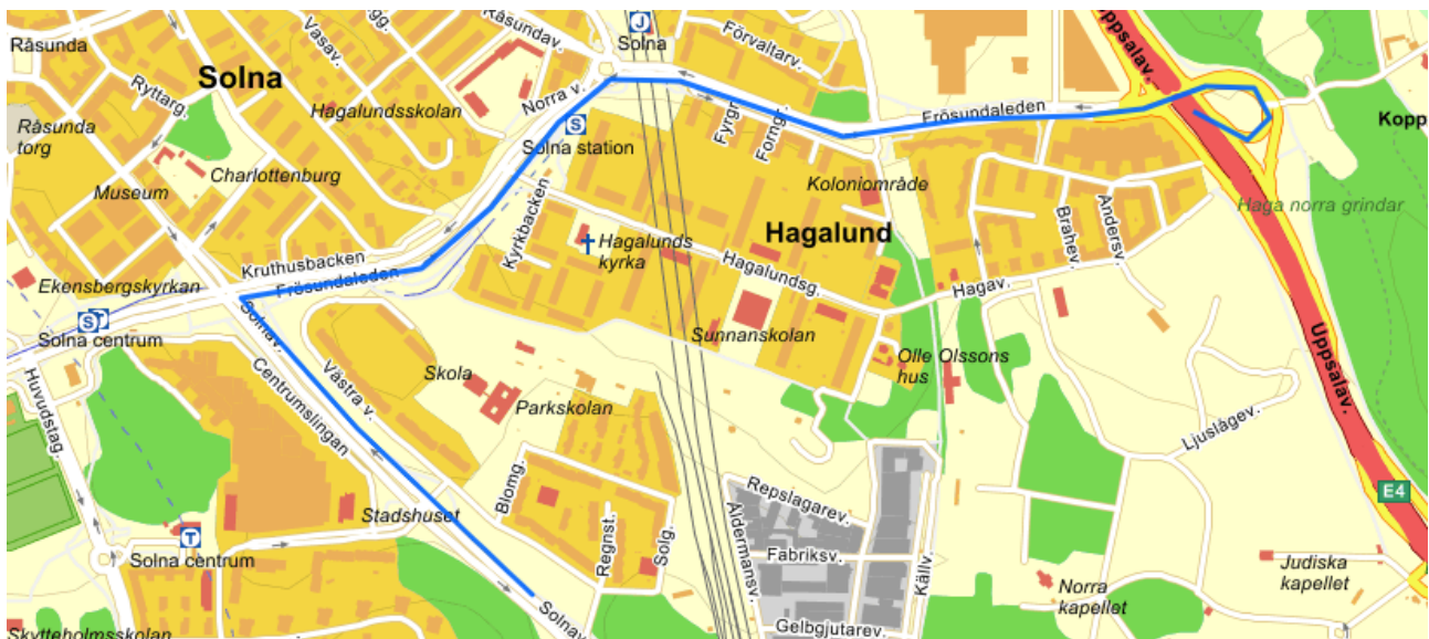
FIGUR 3. KÖRVÄG UT MED BERGMASSOR FRÅN ETABLERINGSOMRÅDET TILL E4:AN.
