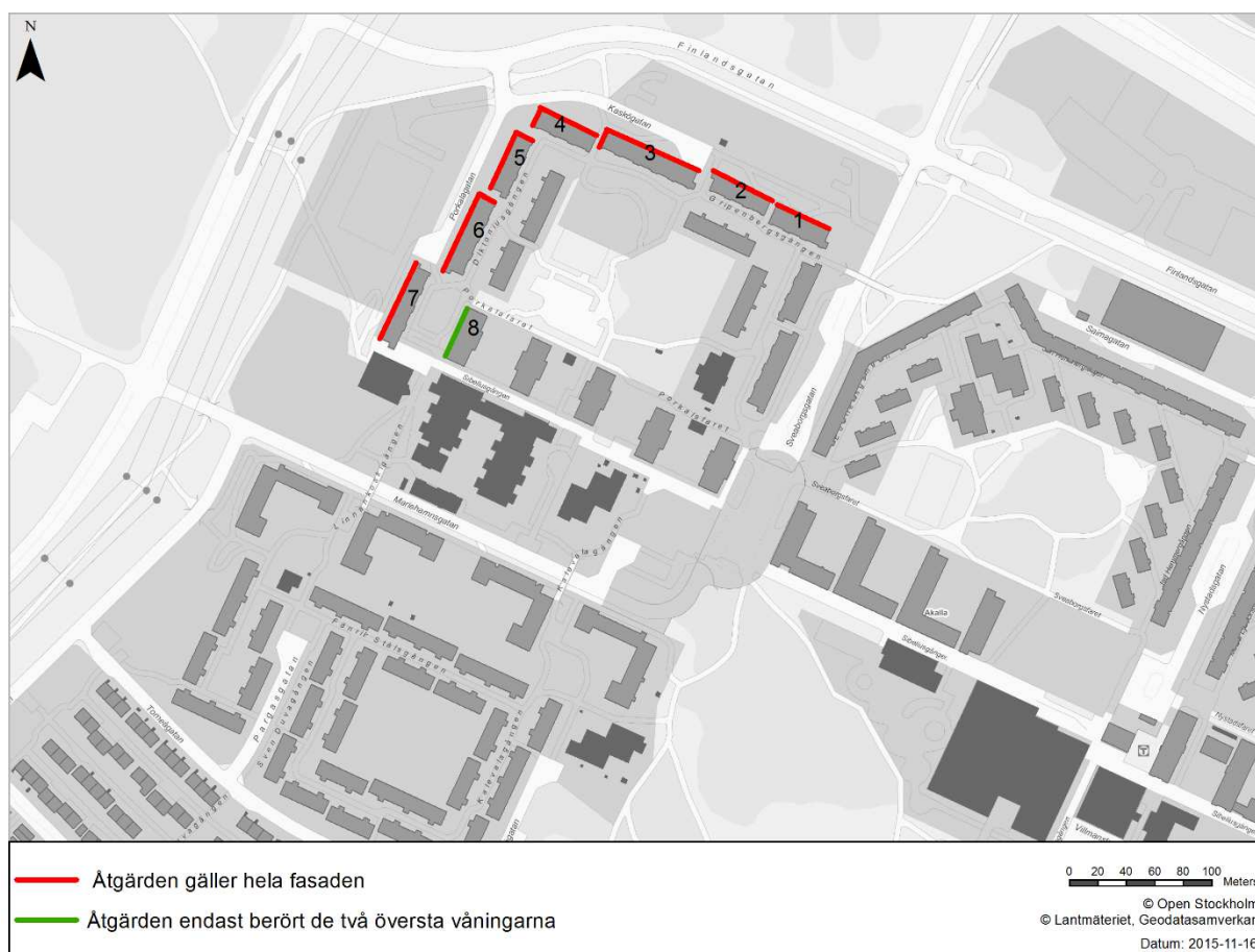
Figur 43. Fasader där fönsteråtgärder vidtagits med anledning av Förbifart Stockholm. Röd markering innebär att åtgärden gäller hela fasaden, grön markering innebär att åtgärd endast berört de två översta våningarna.
