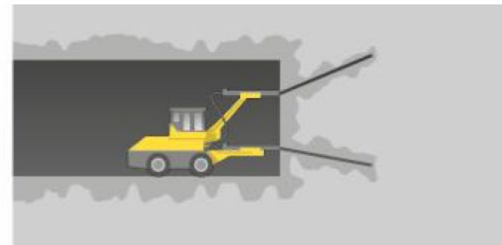
Injekteringsbruk sprutas in i borrhål och sprickor
